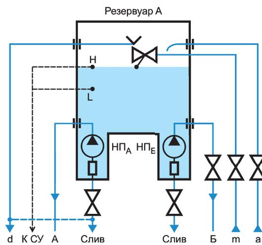
Рисунок В.2 — Схема противопожарного водоснабжения ВПВ или ВПВ, совмещенного с АУП, и/или с ХПВ, или с производственным водопроводом из одного пожарного резервуара (при наличии приемка для каждого пожарного насоса)
