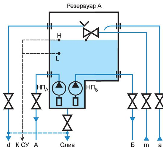
Рисунок В.3 — Схема противопожарного водоснабжения ВПВ или ВПУ, совмещенного с АУП, и/или с ХПВ, или с производственным водопроводом из одного пожарного резервуара (при наличии общего приемка для всех пожарных насосов)
