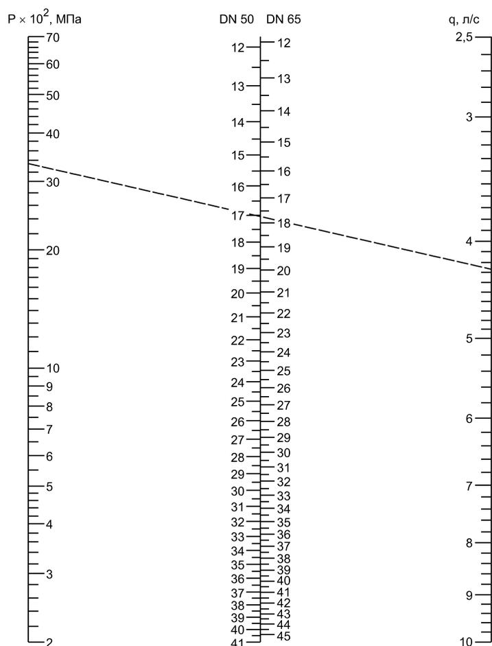
$P$  — давление у пожарного крана, МПа; DN 50 — диаметр отверстия диафрагмы, устанавливаемой у пожарного крана DN 50; DN 65 — то же у пожарного крана DN 65;  $q$  — расход ПК-с, л/с
