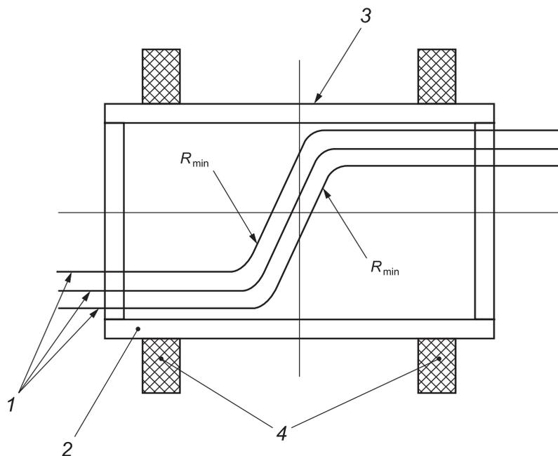
1 — кабель; 2 — короб (лоток); 3 — место стыка короба (лотка); 4 — стенки печи;
