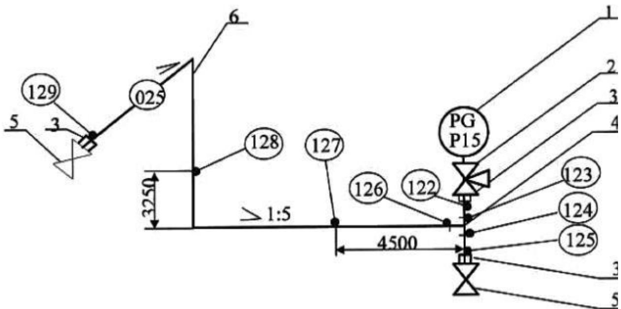
Номера сварных швов по журналу сварки трубопроводов
