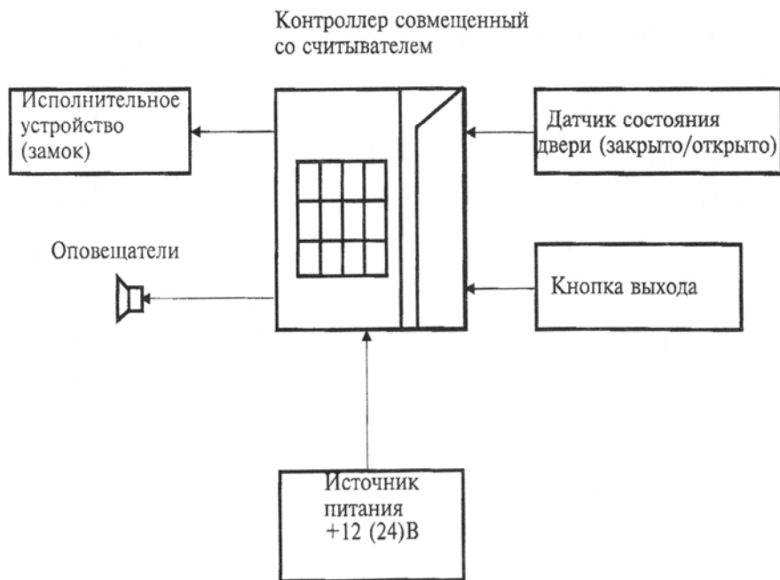
Рисунок 1 – Оборудование СКУД помещения с одной дверью
